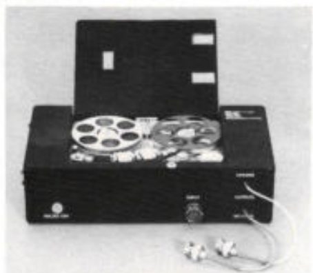
Afb. 5. Miniatuursysteem voor PCM-registratie (Kayser).
