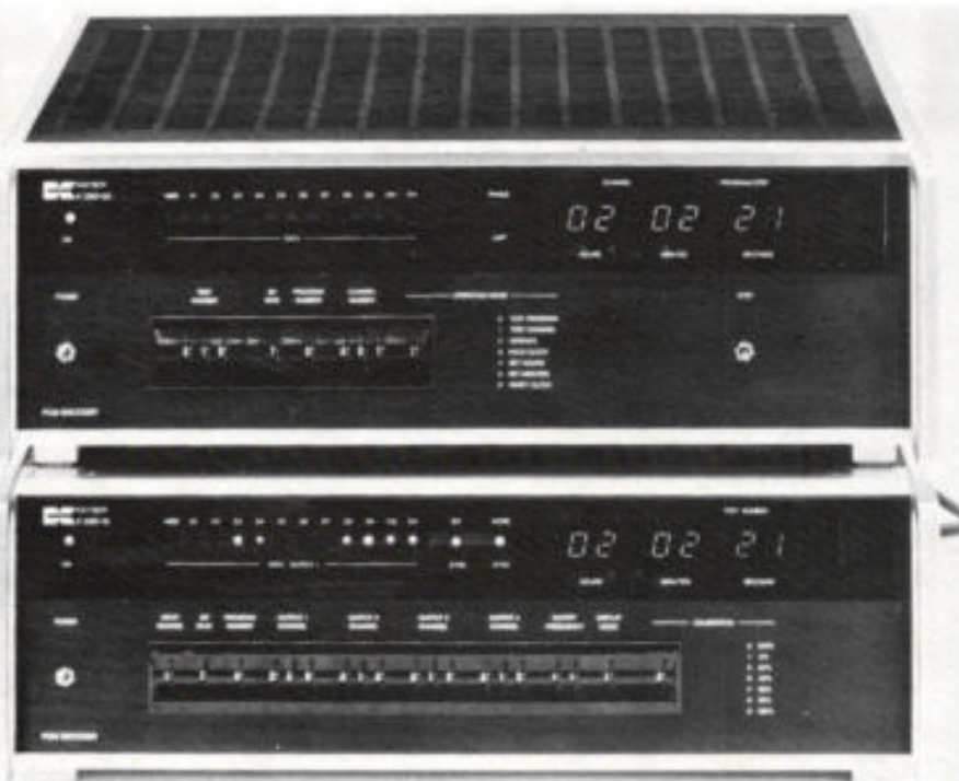
Afb. 4. Encoder K1280-03 (boven) en decoder K1280-13 voor PCM volgens IRIG-standaard.
