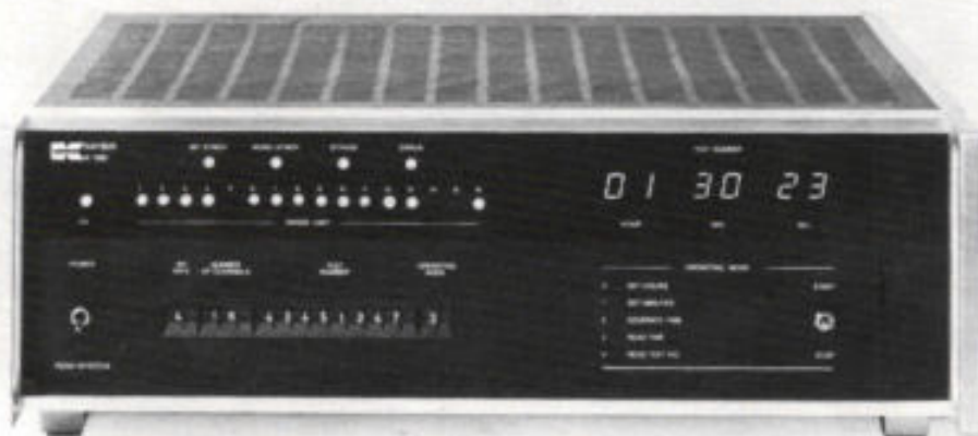
Afb. 3. Encoder/decoder-eenheid K1180 voor PCM volgens DIN-standaard.
